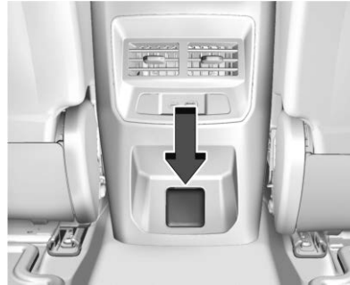
Parte trasera de tomacorriente de consola central.
