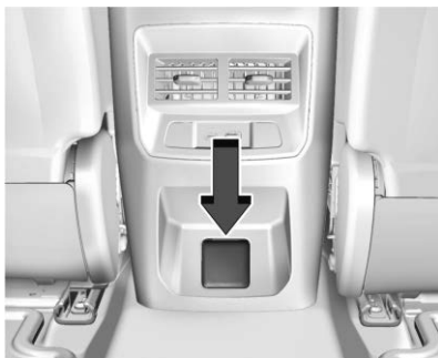
Parte trasera de tomacorriente de consola central.
